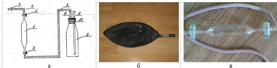
Приборы для отбора пробы газа
