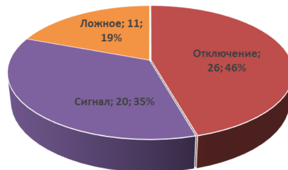
Рисунок 1 - Характер срабатывания газовой защиты 54 силовых трансформаторов за период 2007-2017 годы.
